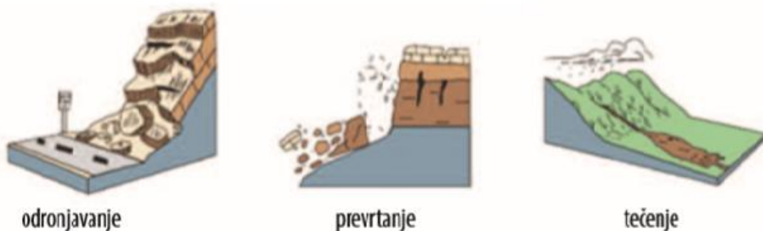
Slika 25. Prikaz osnovnih tipova klizanja prema mehanizmu kretanja
